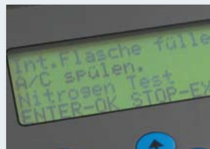
Vérification entièrement automatique des fuites à l'azote
