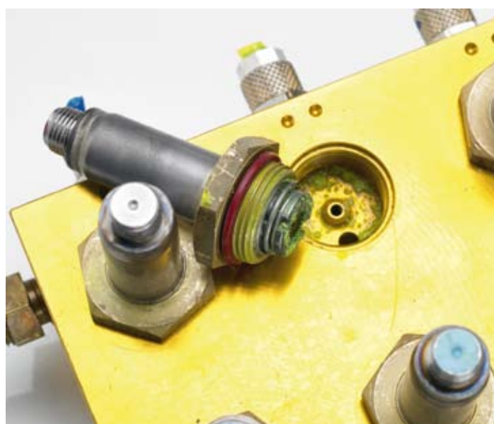
Effet du produit d'étanchéité dans la station de charge sans utilisation du Recycle Guard
